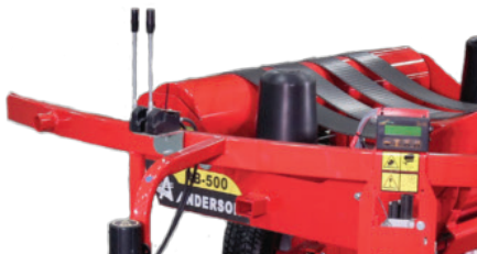
Leviers de contrôle hydraulique
