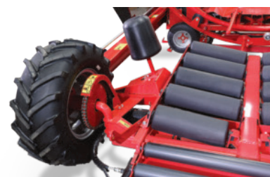
Pont ajustable pour balles rondes ou carrées
