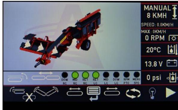
**Abbildung 39 – Betrieb Einzelförderband - Linkes Förderband**
