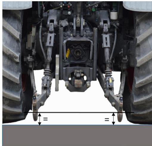
Horizontale Einstellung der Unterlenker des Traktors:
