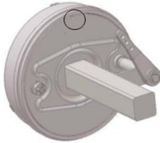
**Abbildung 71 — Inspektionsfenster für Bremsenverschleiß**
