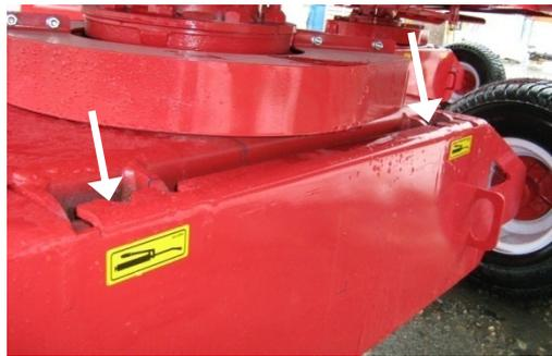
Roulements des deux rouleaux d'entraînement des courroies (1 à chaque bout, total 4)
