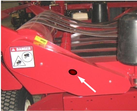
**Figure 6.3** Lubrification chaîne (par le trou dans le garde)
