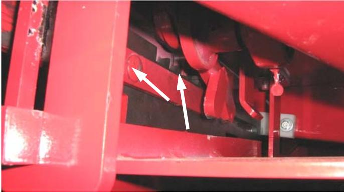
**Figure 6.4** Autre Lubrification coupe plastique 2
