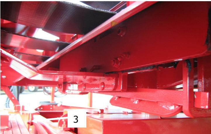
**Figure 5.6** Ajustement du came du coupe plastique (moment de détente)
