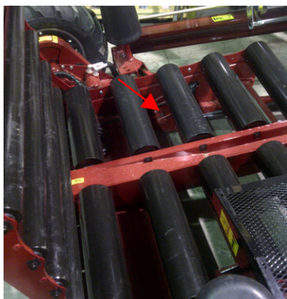
Figure 39 – Deux pivots de l'essieu pivotant
