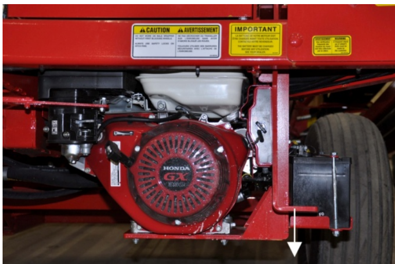
Figure 49 – Ajustement du système automatique (pédale de démarrage)
