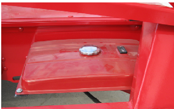
Figure 57 – Réservoir à essence de 25 litres
