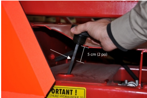
Figure 5 – Niveau d'huile du réservoir hydraulique
