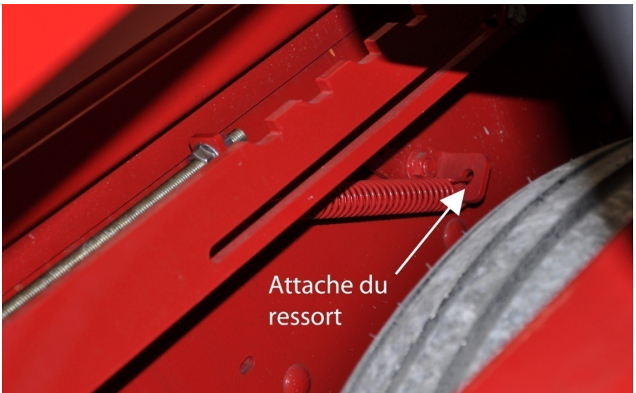
Figure 53 – Ajustement du ressort du système automatique
