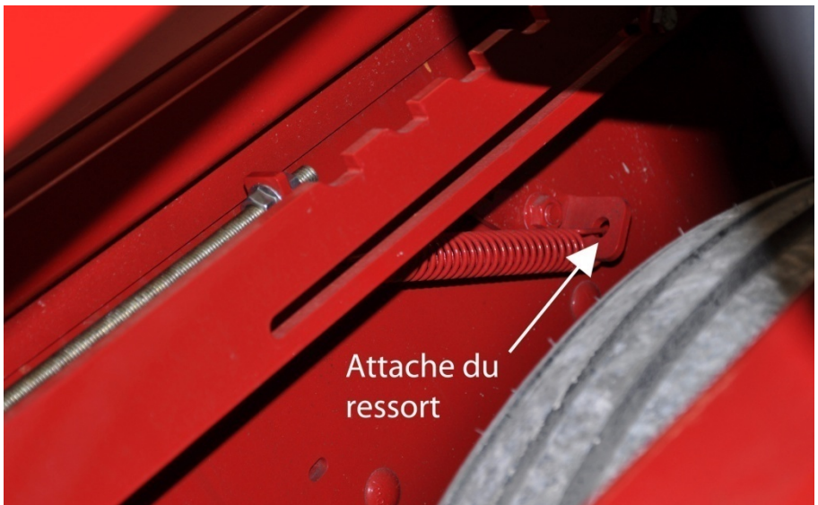
Figure 53 – Ajustement du ressort du système automatique
