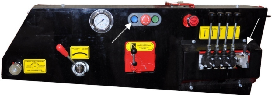
Figure 61 – Panneau de contrôle avec option de conduite à distance
