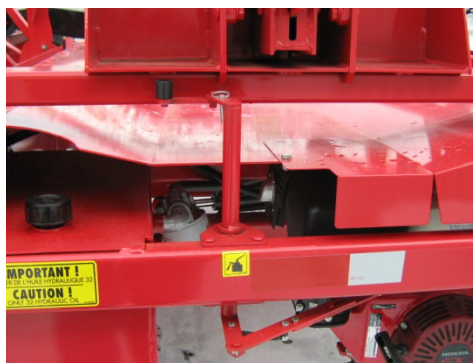
Figure 30 – Contrôle du régime du moteur
