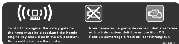
Figure 60 – Étiquette du démarrage et de l'arrêt d'urgence
