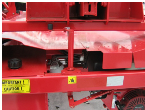
Figure 30 – Contrôle du régime du moteur
