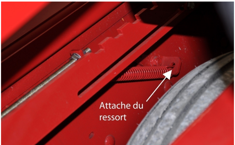
Figure 53 – Ajustement du ressort du système automatique
