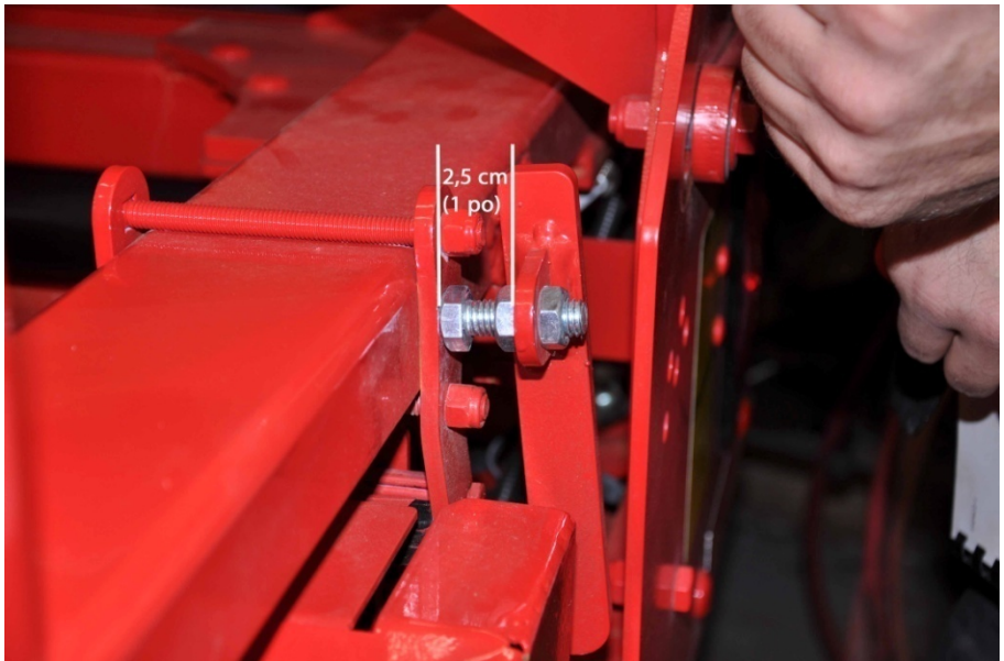
Figure 48 – Ajustement du limiteur de course du poussoir
