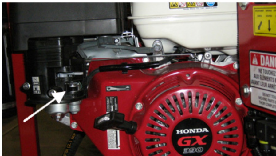
Figure 4 – Fermeture du robinet
