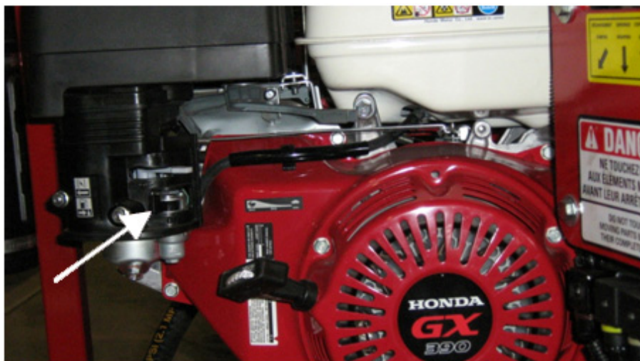
Figure 4 – Fermeture du robinet
