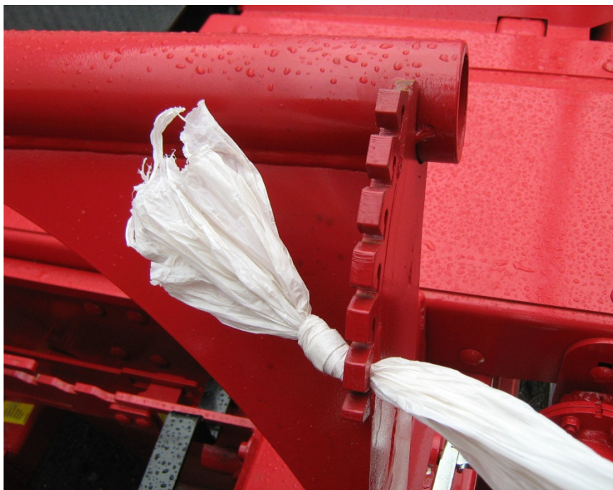
Figure 16 – Fixation de la pellicule au crochet
