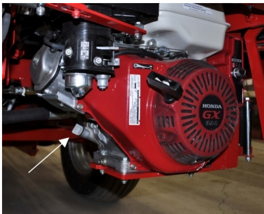
Figure 6 – Emplacement de la jauge d'huile du moteur
