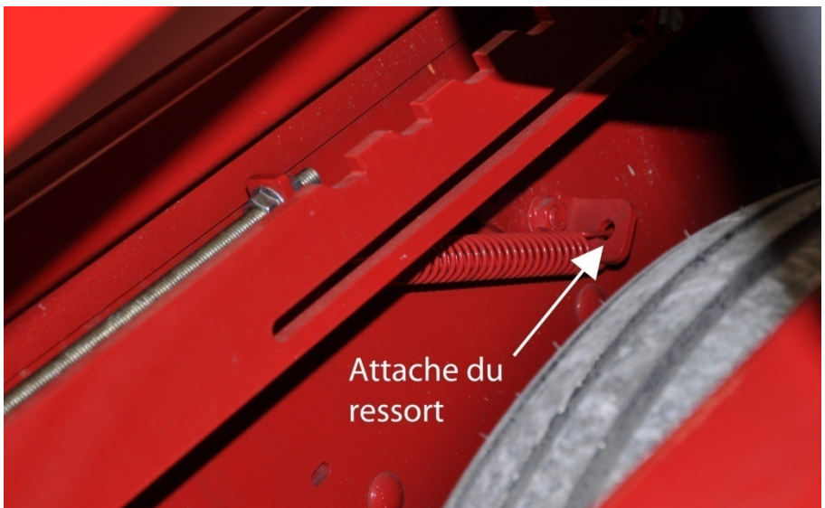
Figure 53 – Ajustement du ressort du système automatique
