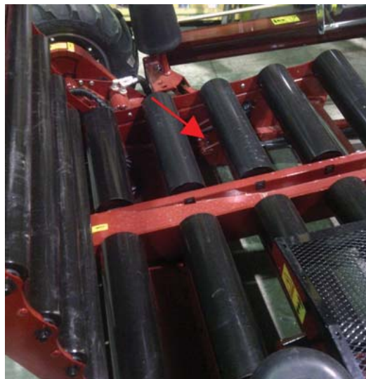
Figure 39 – Deux pivots de l'essieu pivotant
