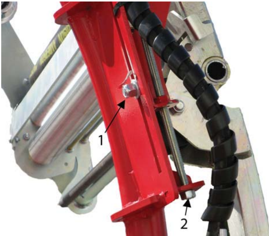
Figure 55 – Ajustement de la roue d'entraînement du cerceau
