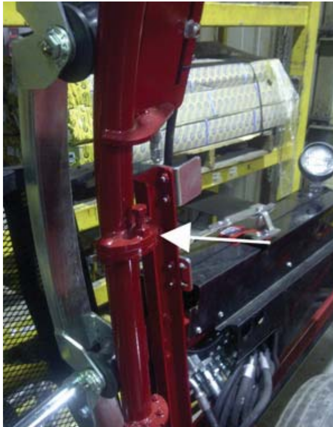
Figure 54 – Ajustement de la tension du cerceau extérieur
