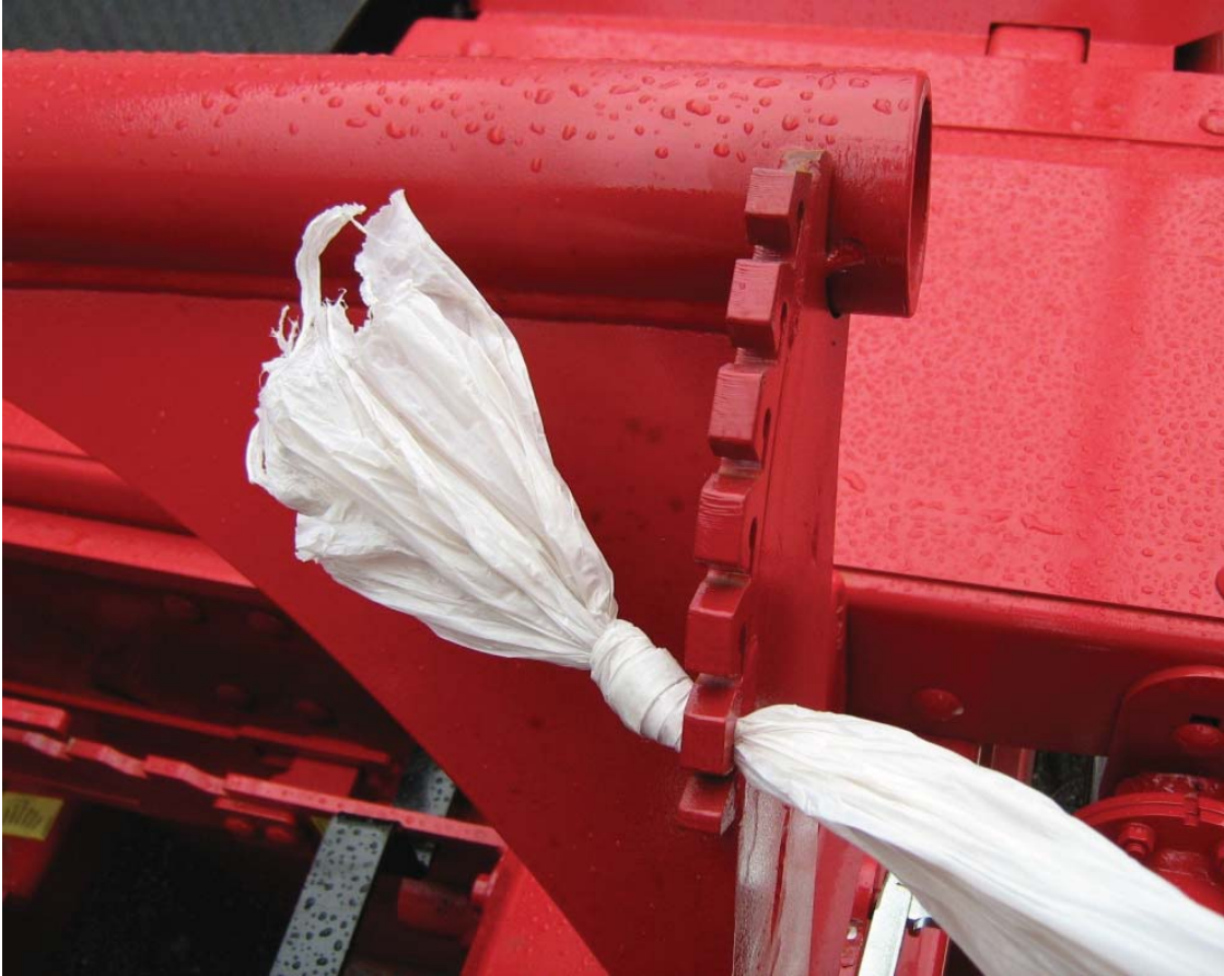
Figure 16 – Fixation de la pellicule au crochet
