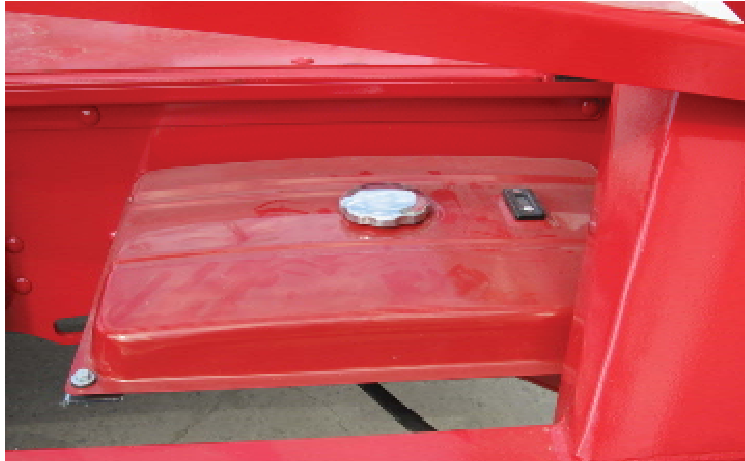
Figure 57 – Réservoir à essence de 25 litres
