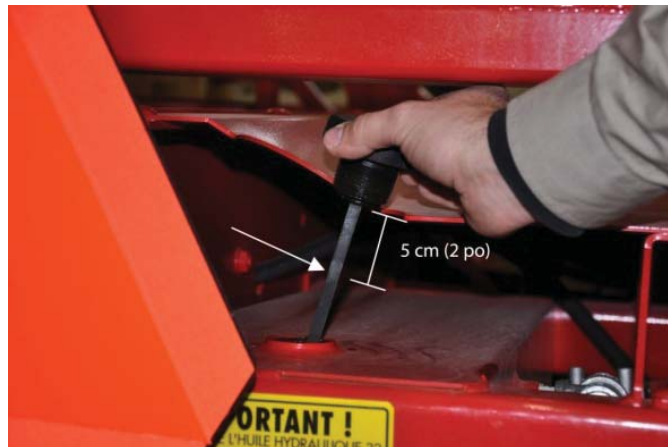
Figure 5 – Niveau d'huile du réservoir hydraulique
