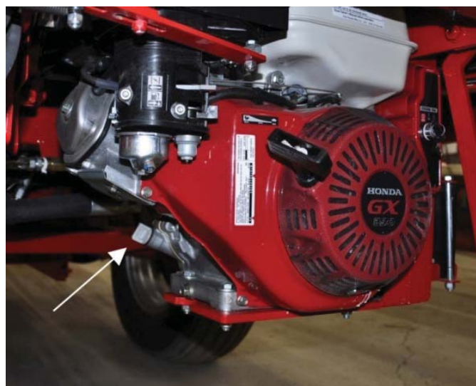
Figure 6 – Emplacement de la jauge d'huile du moteur
