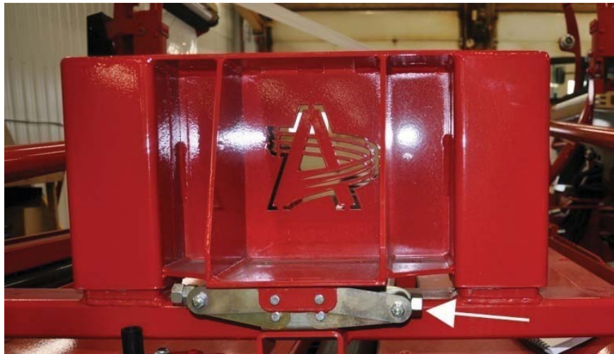
Figure 27 – Ajustement de la hauteur du poussoir
