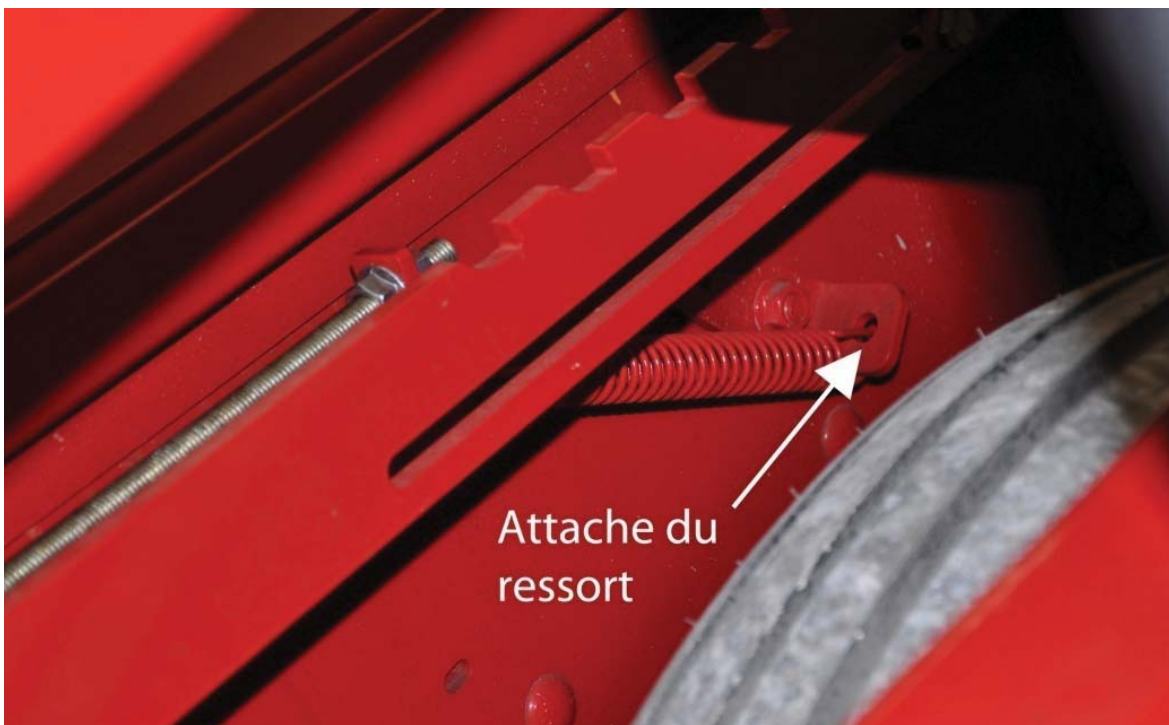
Figure 53 – Ajustement du ressort du système automatique
