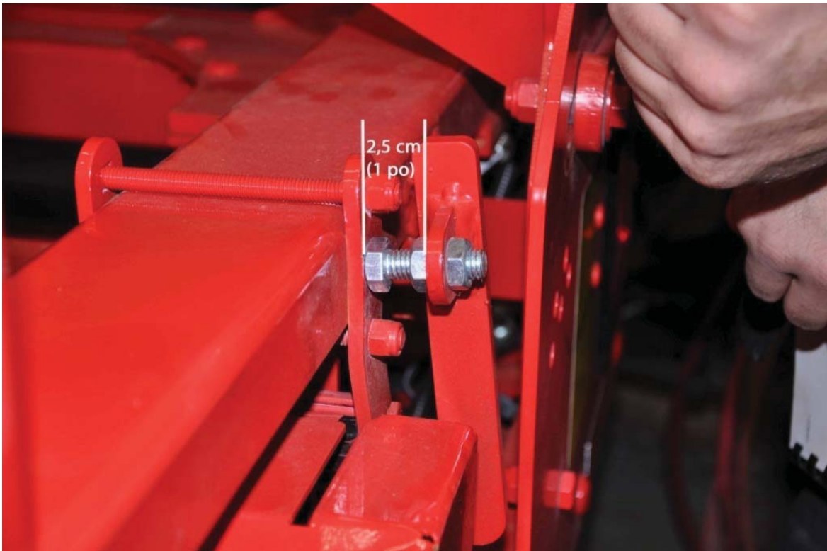
Figure 48 – Ajustement du limiteur de course du poussoir
