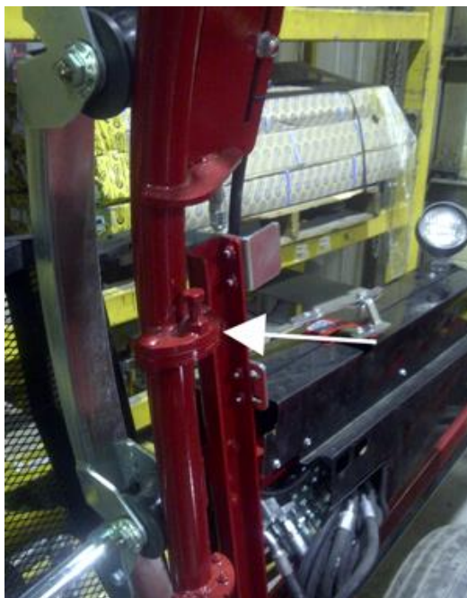
Figure 54 – Ajustement de la tension du cerceau extérieur
