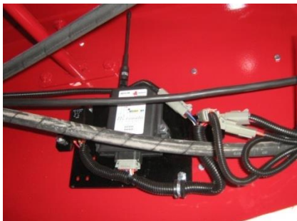
Figure 62 – Le récepteur de la conduite à distance
