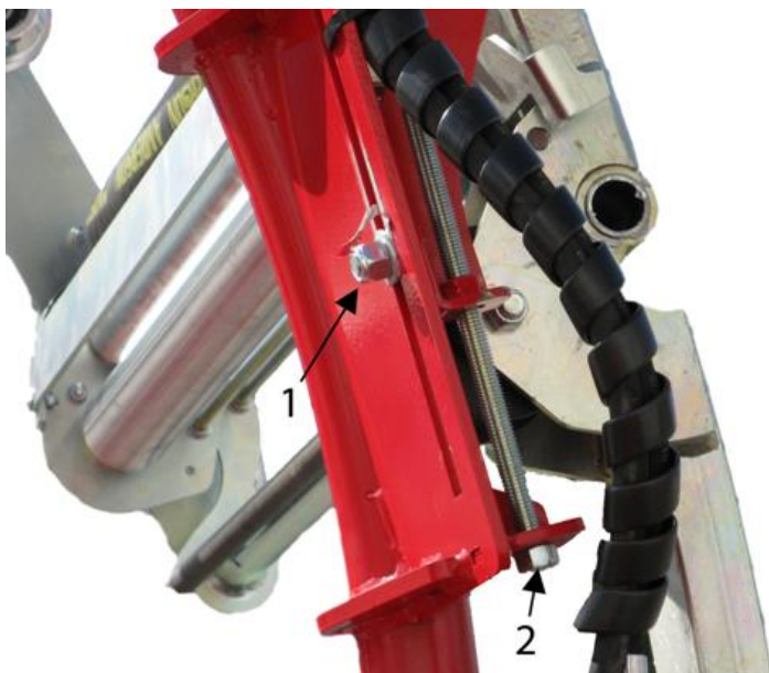
Figure 55 – Ajustement de la roue d'entraînement du cerceau
