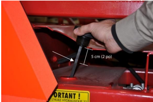
Figure 5 – Niveau d'huile du réservoir hydraulique
