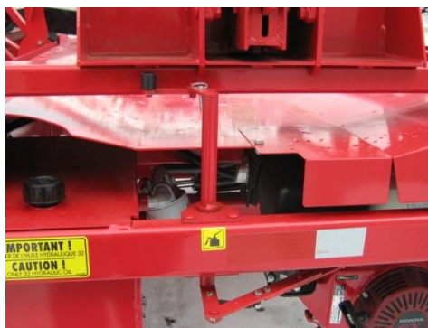
Figure 30 – Contrôle du régime du moteur
