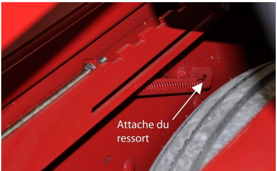
Figure 53 – Ajustement du ressort du système automatique
