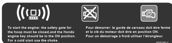
Figure 60 – Étiquette du démarrage et de l'arrêt d'urgence
