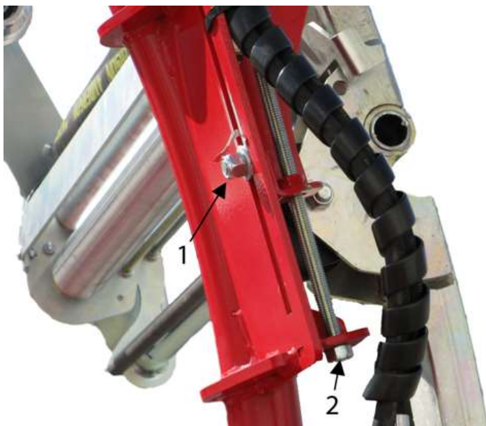
Figure 55 – Ajustement de la roue d'entraînement du cerceau
