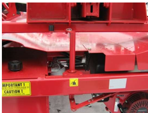
Figure 30 – Contrôle du régime du moteur
