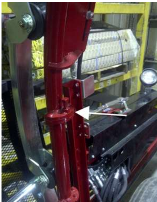
Figure 54 – Ajustement de la tension du cerceau extérieur
