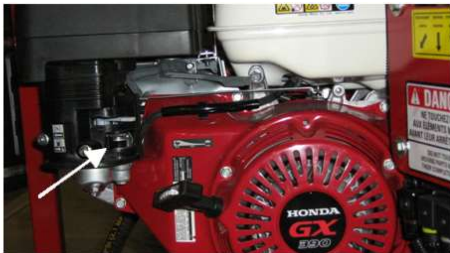
Figure 4 – Fermeture du robinet
