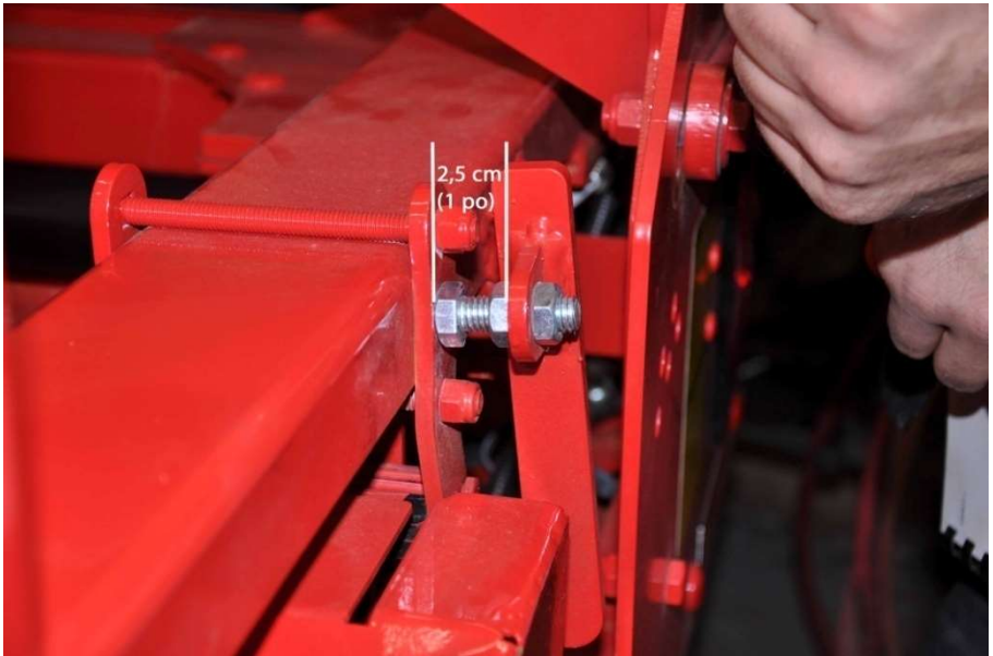
Figure 48 – Ajustement du limiteur de course du poussoir
