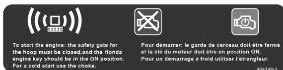
Figure 60 – Étiquette du démarrage et de l'arrêt d'urgence
