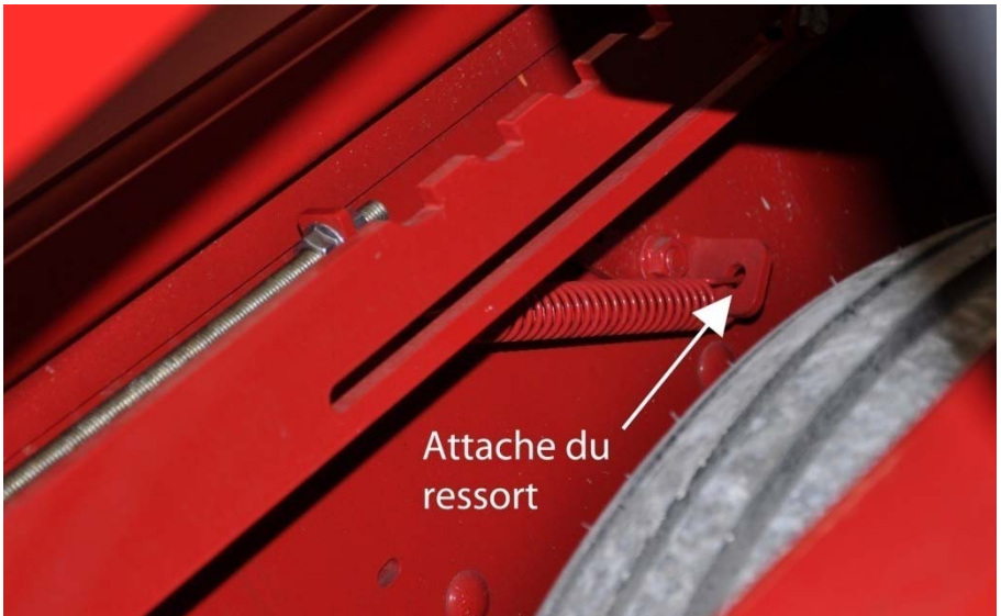
Figure 53 – Ajustement du ressort du système automatique
