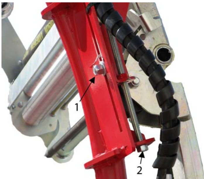
Figure 55 – Ajustement de la roue d'entraînement du cerceau
