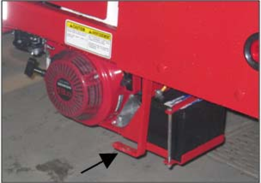
Figure 43 – Ajustement du levier actionneur du cerceau (déclencheur manuel du poussoir)
