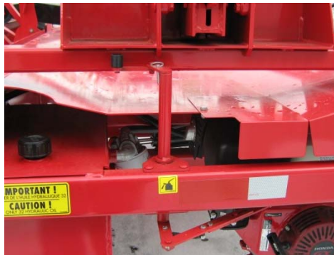
Figure 30 – Contrôle du régime du moteur
