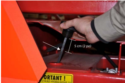
Figure 5 – Niveau d'huile du réservoir hydraulique
