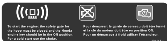
Figure 60 – Étiquette du démarrage et de l'arrêt d'urgence
