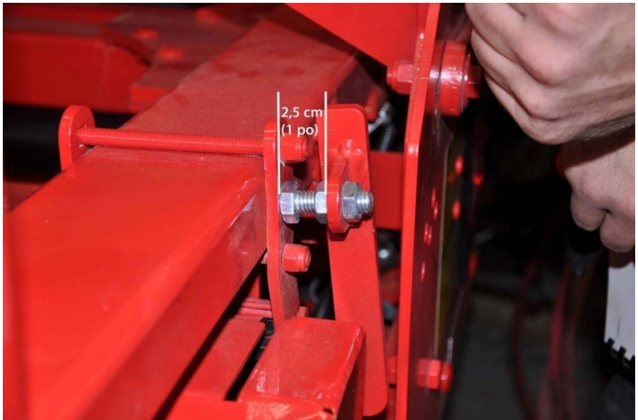
Figure 48 – Ajustement du limiteur de course du poussoir
