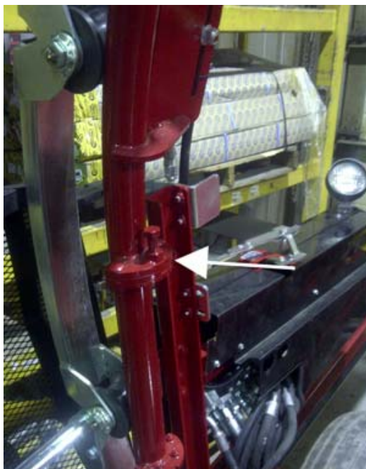
Figure 54 – Ajustement de la tension du cerceau extérieur
