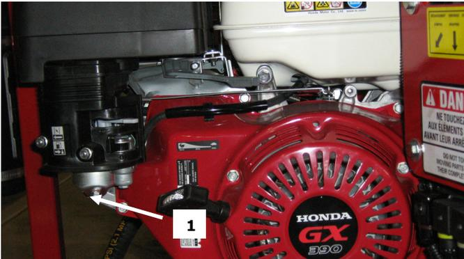
Figure 1.1 Fermeture du robinet
