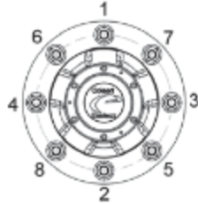
рисунок 44 — Порядок затяжки гаек
