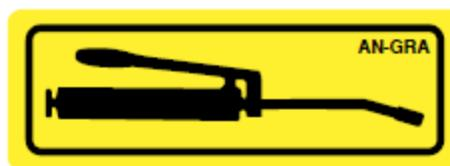
рисунок 40 — Указатель точки смазки
