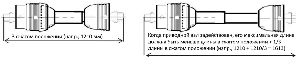
**рисунок 11 — Пример измерения длины приводного вала**
