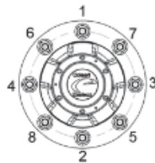
рисунок 44 — Порядок затяжки гаек
