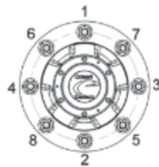
рисунок 45 — Порядок затяжки гаек
