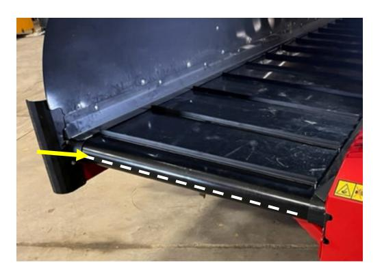
5- Pousser le rouleau de traction au maximum vers l'intérieur. Démonter la goupille du système du tendeur de courroie pour réaliser cette étape
