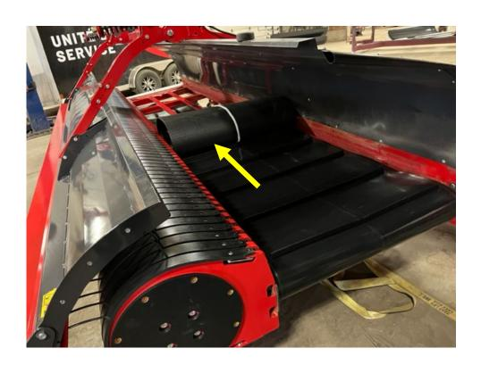
11- Mettre les joints de la courroie au centre du bâtit transversal de l'unité. Nous nous servirons de celui-ci comme appui pour glisser le lacet dans le joint alligator
