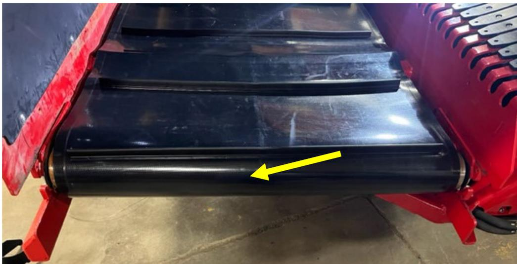
25- Réassembler le tendeur de courroie et tendre la courroie.
