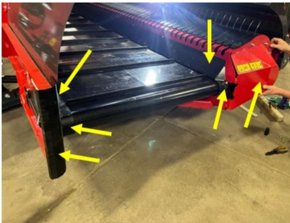
27- Ajuster les plaques pour qu'il y ait minimum  $\frac{1}{4}$ " d'espace partout entre les plaques et la courroie.
