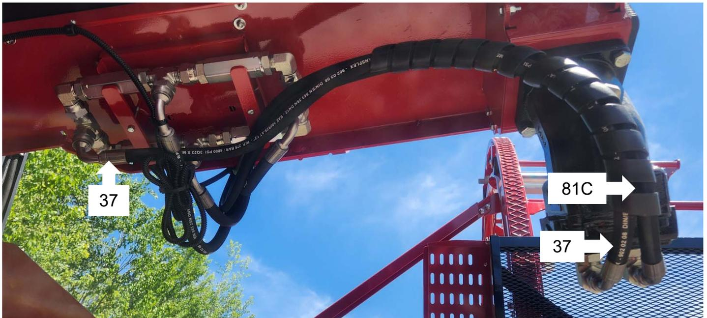
2- Boulonner la valve sur le châssis du convoyeur près du moteur de convoyeur.
