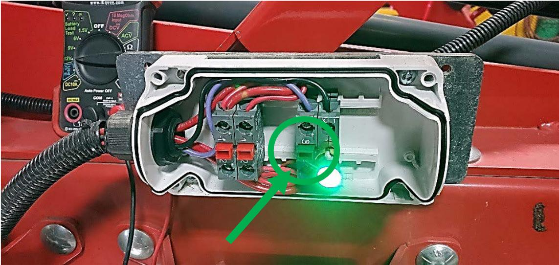
8. Si le moteur démarre seulement lorsque que les deux boutons d'arrêt d'urgence sont débranché, le bouton rouge d'arrêt d'urgence pourrait être activé. Si il n'est pas aligné correctement, le coin de plastique (#1-2-3-4) poussera le connecteur ce qui empêchera le moteur d'activer le régulateur de charge de la batterie. L'ordinateur continuera de purger l'énergie de la batterie. Simplement réaligner les coins pour résoudre le problème.
