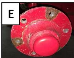
4. Retirer le boulon et son écrou du lien de conduite (à l'aide d'une clé 1 1/16 et d'une douille 1 1/8 (D));
