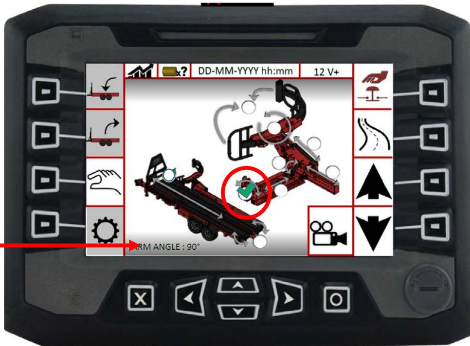
c. Puis cliquez sur la flèche pointant vers le bas jusqu'à ce que le cylindre principal du bras de chargement soit pleinement rétracté.
