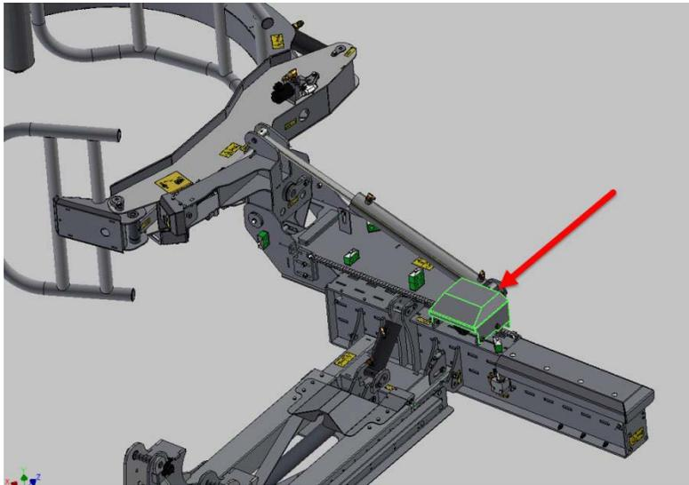
2. Dévissez l'écrou à blocage et serrez la vis d'un demi-tour, puis testez si la force est assez grande, dans le cas contraire, resserrez d'un demi-tour et testez de nouveau ...
