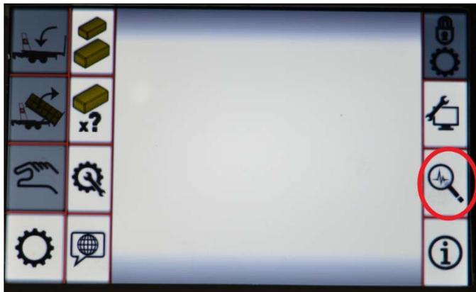
Regarder le status du capteur LS\_ED\_M. Si le capteur est aligné avec l'aimant le status devrait être à ON(Vert), autrement il devrait être à OFF (Rouge). Déplacer l'extension du dompeur avec le levier à action manuel et regarder l'état du capteur. **Ne pas oublier de rétracter l'extension du déchargeur avant de abaisser celui-ci.**
