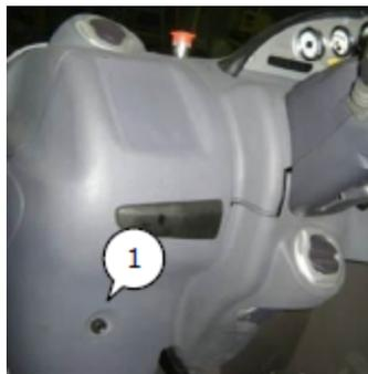
**Figure 63 — Emplacement du réservoir de lave-glace**
