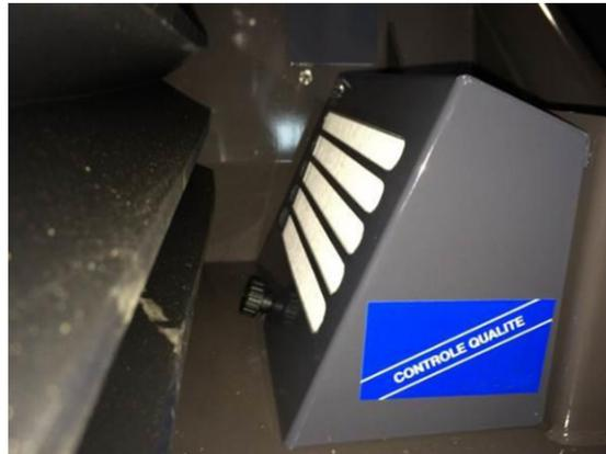
**Figure 92 — Filtre de ventilation de la cabine**
