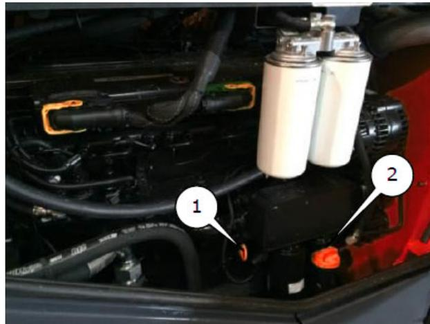
**Figure 74 — Jauge et orifice de remplissage d'huile du moteur thermique**
