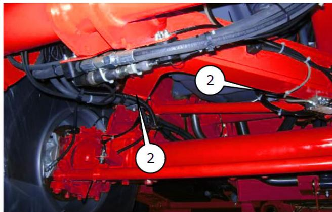
**Figure 87 — Points de graissage de l'essieu avant**
