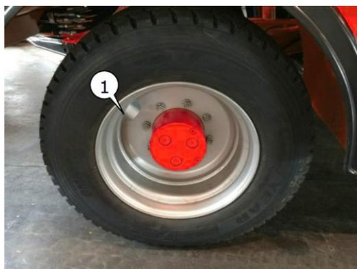
Figure 91 — Contrôle de la pression des roues et du serrage des écrous
