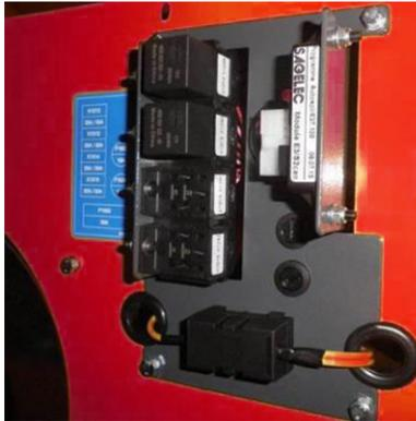
**Figure 97 — Emplacement des fusibles et des relais de moteur et de rétroviseur**
