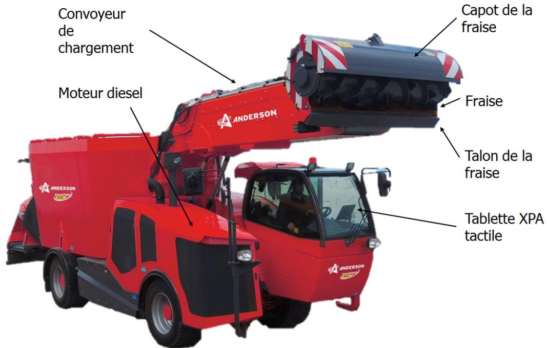
**Figure 2 – Principaux composants du mélangeur automoteur (2 de 2)**
