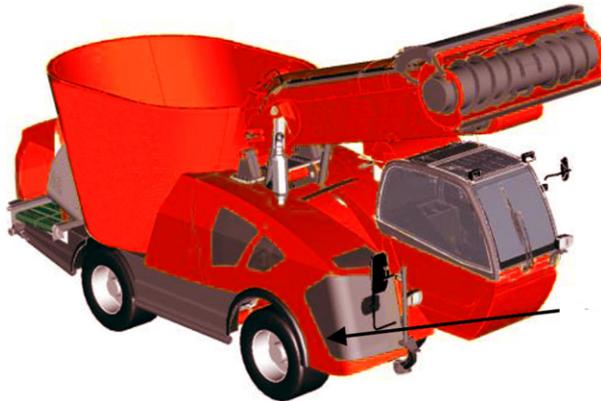
**Figure 4 — Emplacement de la plaque signalétique du mélangeur**
