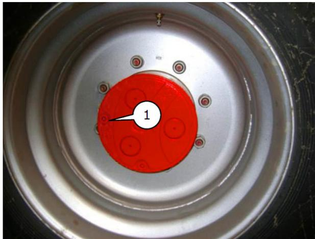
**Figure 85 — Bouchon pour l'huile des réducteurs de roue**
