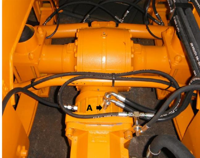
**Figure 53 — Flexible du frein de stationnement**
