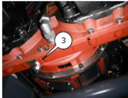
**Figure 57 — Bouchon de vidange de la boîte de répartition**
