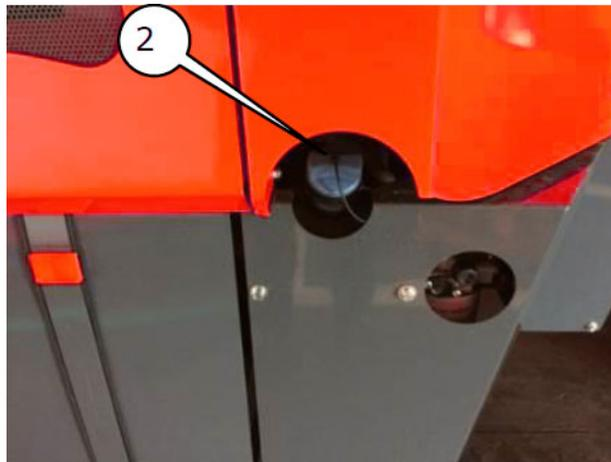
**Figure 81 — Orifice de remplissage du liquide antipollution (AdBlue)**
