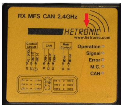
**Figure 3 - Panneau de contrôle du récepteur**
