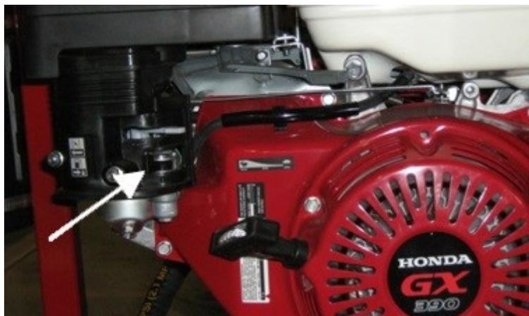
**Figure 6 - Robinet d'arrivée de carburant du moteur**
