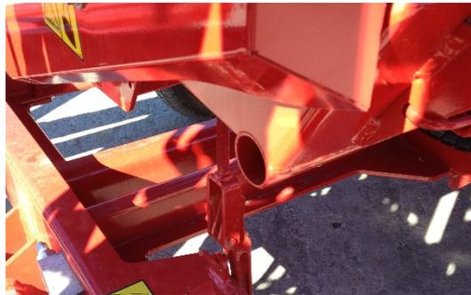
**Figure 5 - Fixation de la table pivotante**
