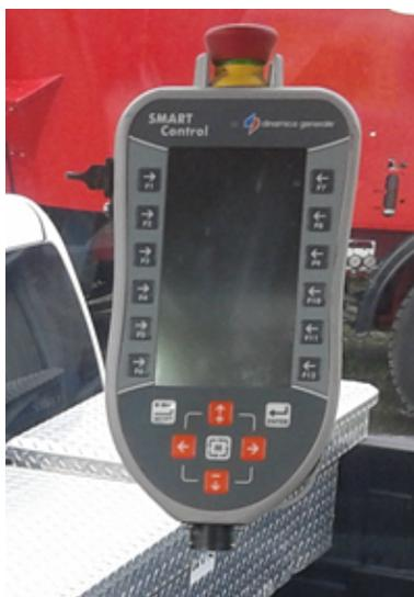
**Figure 18 - Installation de la commande à distance Smart-Control**
