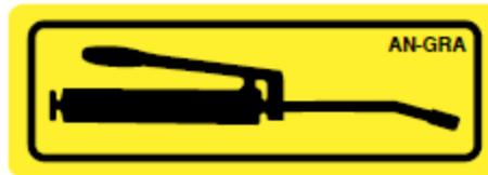
**Figure 43 — Identificateur de points de graissage**
