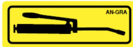
**Figure 22 — Identificateur de points de graissage**
