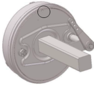
Figure 52 — Fenêtre de contrôle de l'usure des freins
