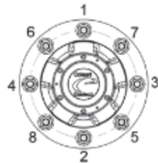
Figure 46 — Ordre de serrage des écrous
