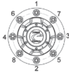
Figure 35 — Ordre de serrage des écrous
