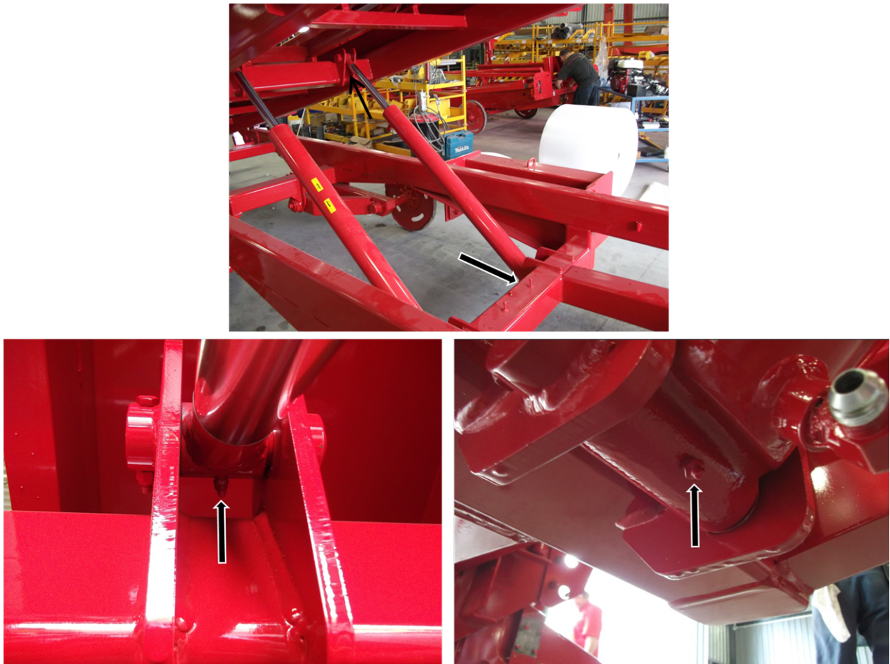
Figure 34 – Articulations des cylindres de la plateforme de déchargement
