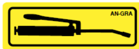
Figure 29 – Identificateur de point de graissage
