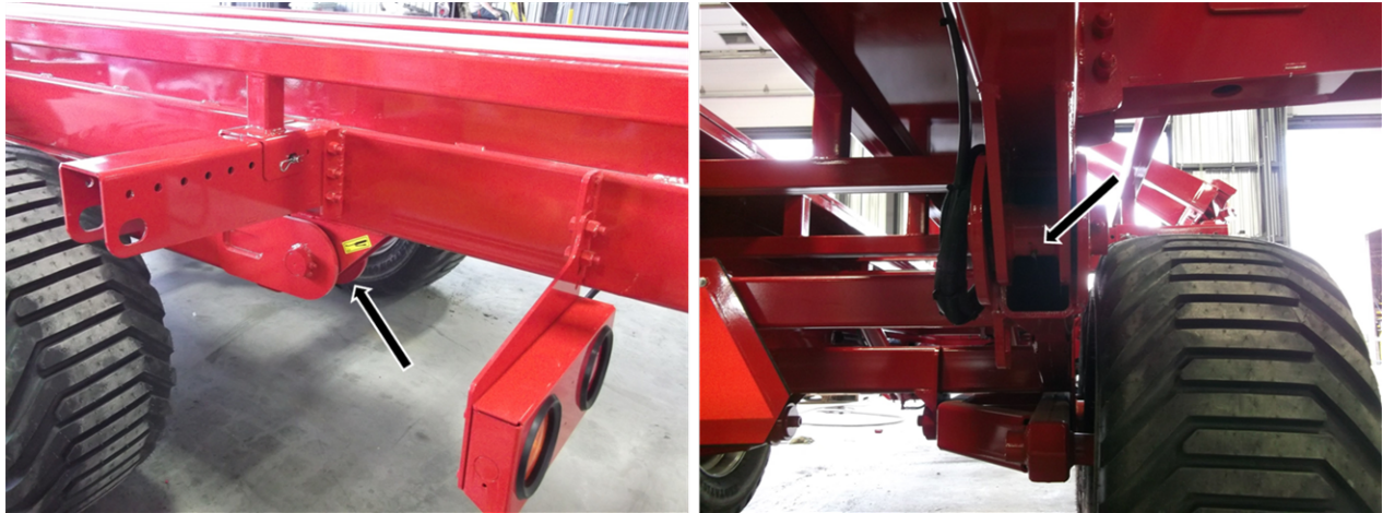
Figure 33 – Pivot de la plateforme de déchargement (dessous)
