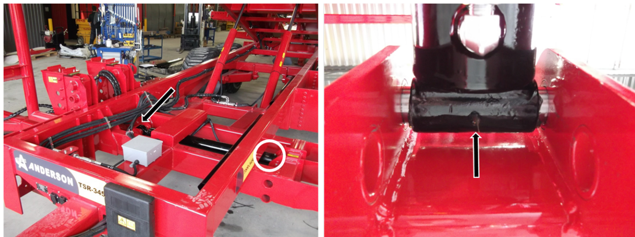
Figure 31 — Articulations du cylindre du bras de chargement
