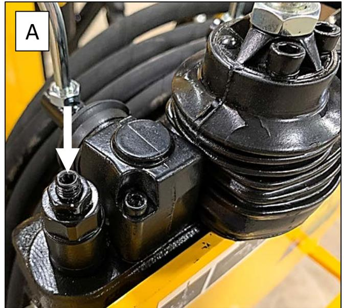
**Note:** Si vous êtes en mode dépannage (sans manomètre) ou que le tracteur est incapable de monter à 3000 psi, chaque ajustements propose un approximatif de tour à dévisser le « port relief » une fois vissé au fond.
