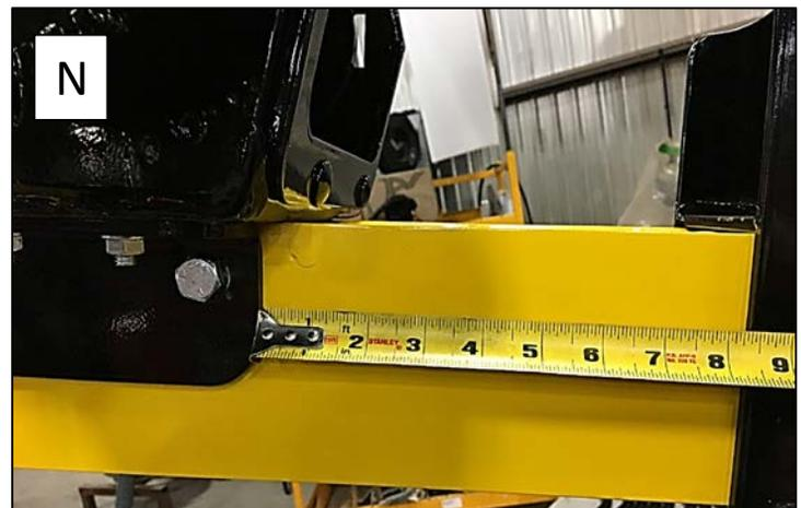
15- Installer les boulons (1/2 X 4 po fournis) du support du bec à une distance d'environ 8 1/2 pouces du treuil (N) à l'aide d'une douille et d'une clé 3/4.
