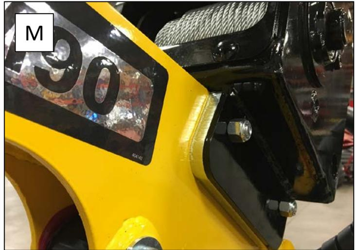
14- Installer le treuil sur le bras vis-à-vis les trous percés à cet effet. Installer les boulons (1/2 X 4 1/2 po fournis) à l'aide d'une douille et d'une clé 3/4.
