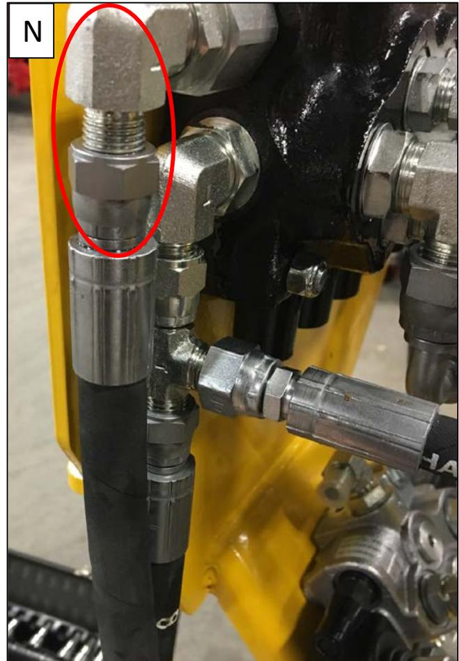
13- À l'aide d'une clé  $\frac{3}{4}$ , installer l'autre extrémité du boyau #28 à l'adaptateur du haut sur la valve d'option (O).
