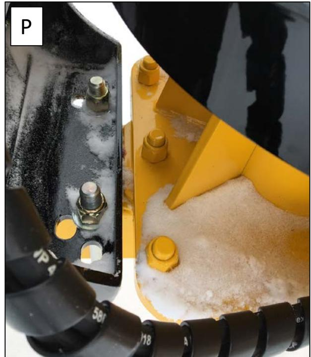
15- Installer les boyaux fournis, côtés des 90 degrés, au moteur du treuil. Le boyau #22 va à l'adaptateur du haut et le #23 à l'adaptateur du bas.
