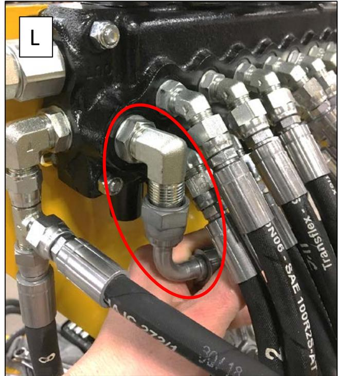
11- À l'aide d'une clé  $\frac{3}{4}$ , installer l'autre extrémité du boyau #29 à l'adaptateur du bas sur la valve d'option (M).
