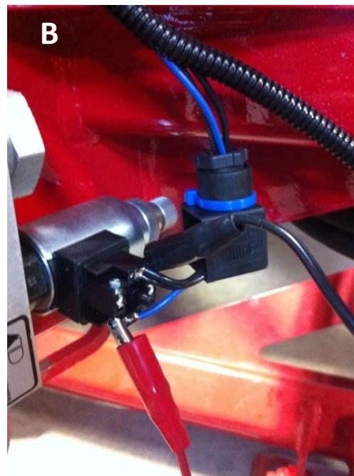
Une fois le voltmètre connecté, faire fonctionner la machine en mode automatique et vérifier le voltage. Si le voltage obtenu de la valve est correct, vous pouvez avoir à vérifier le spool ou remplacer la valve. (Assurez vous que la vis d'ajustement est complètement dévissée). S'il n'y a pas de voltage à la valve, vous devez faire la vérification du harnais allant de la valve à l'ordinateur.
