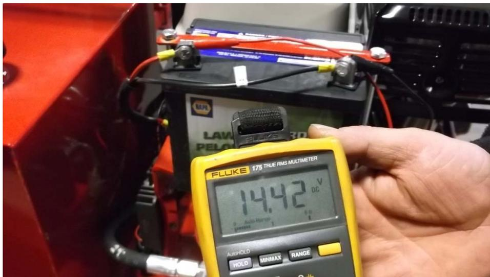
Photo d'une batterie neuve pendant que le moteur est en marche.
