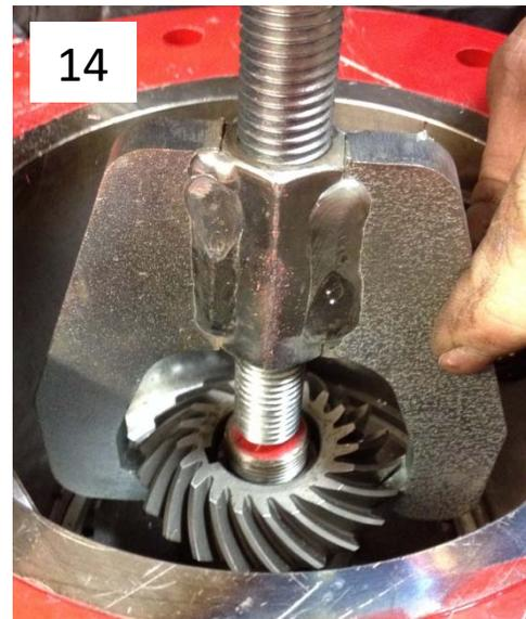
13- Enlever la rondelle (de métal). Enlever le roulement à l'aide de l'outil extracteur de roulement (#223244, photo 15) spécialement conçu par Groupe Anderson. Il suffit de l'insérer et de visser l'ajustement (photo 16). La pièce sortira en même temps que l'outil.
