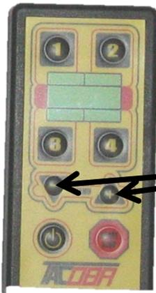
Pour passer du mode MENUS au mode d'Ajustement (ou vice-versa), simultanément appuyer sur les boutons [+] and [-], puis relâcher.
