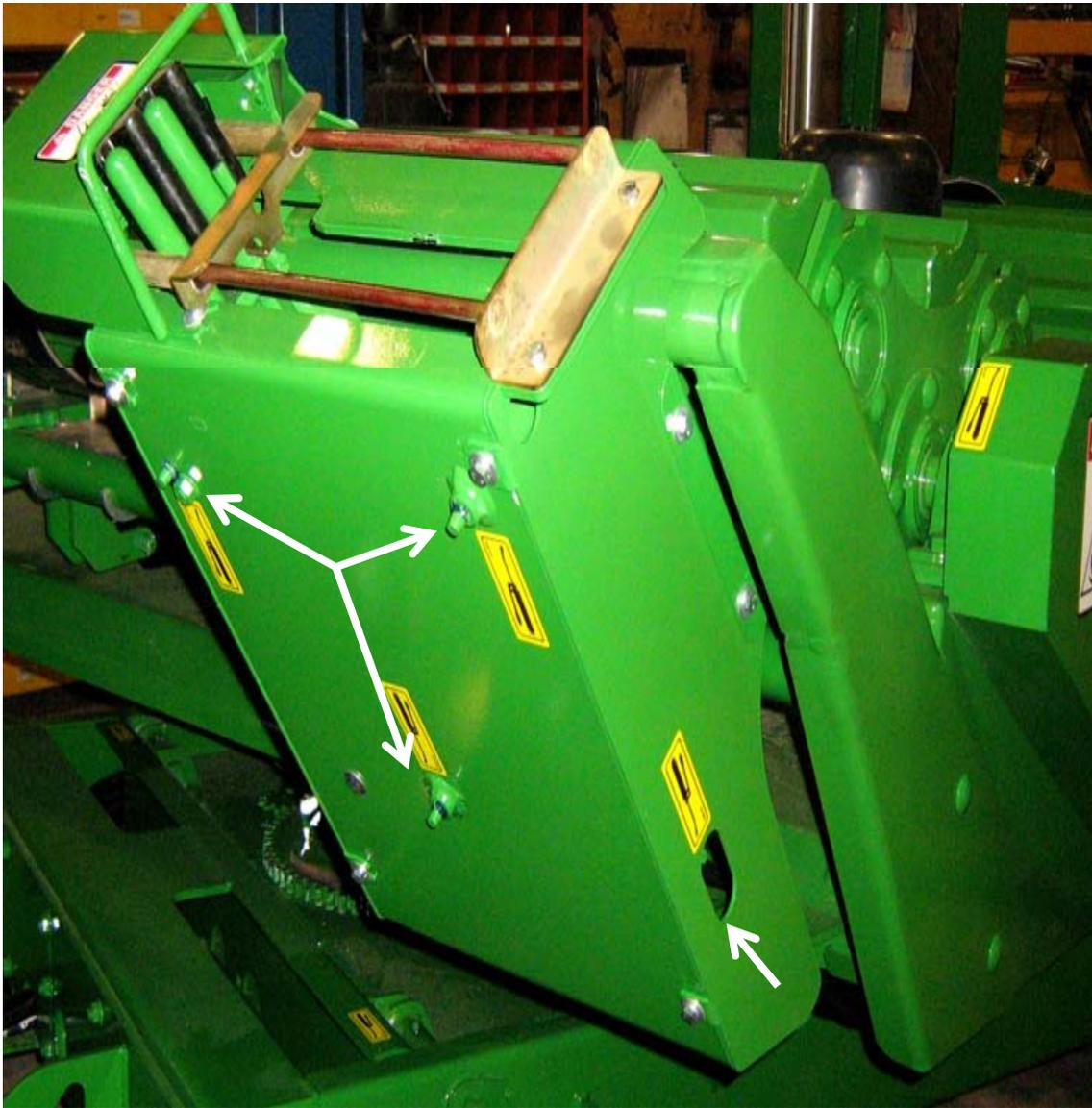
Adaptateur de graissage du coupe-plastique
