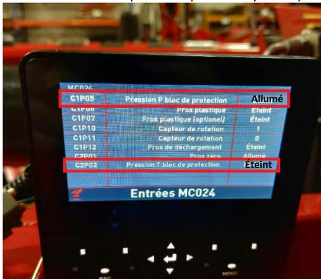
i. La ligne où il est écrit "CP105 -Pression P bloc de protection" **doit être allumé** quand l'hydraulique est activé dans le tracteur.
