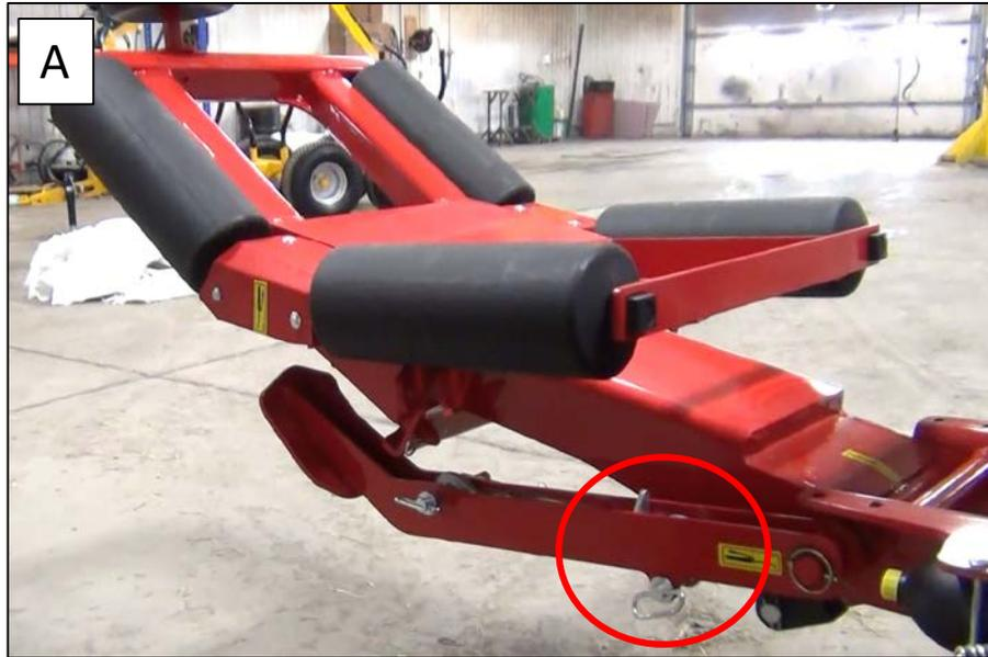
2. Insérer la barre 3 points (top link) de la patte au plateau de déchargement (B).
