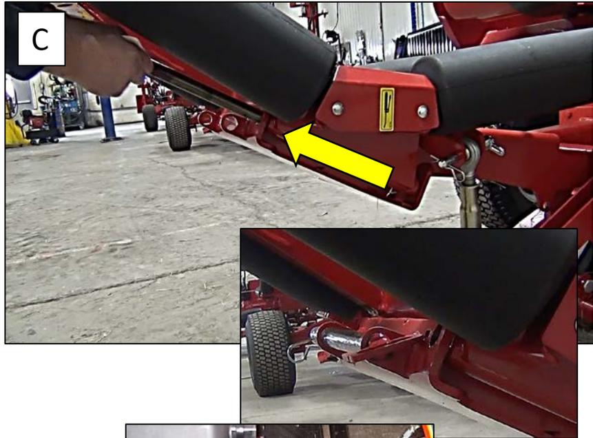
4. Retirer le couvert de la table à l'aide d'une clé 9/16 puis installer le rouleau d'appui dans le trou du même côté que la patte.
